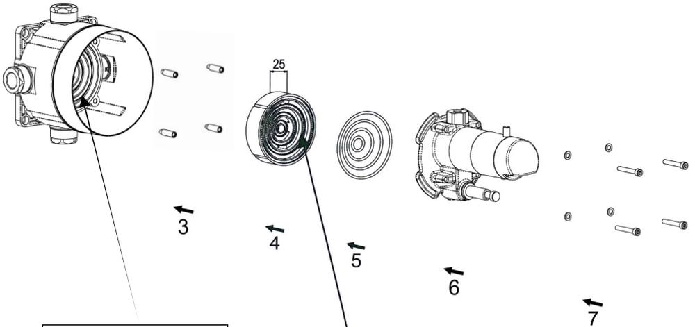
Korrekte Position der 4 O-Ringe überprüfen
